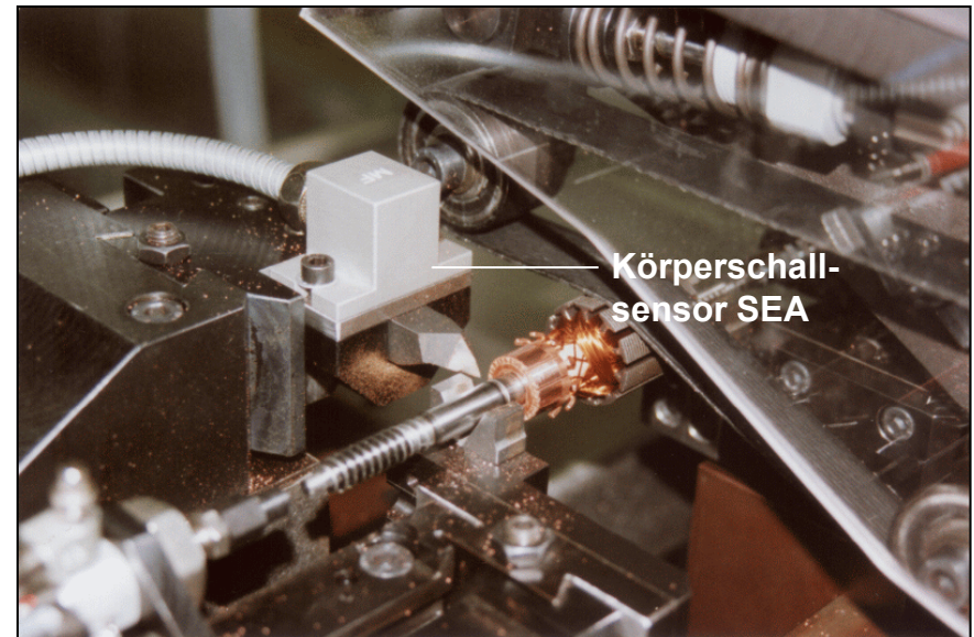
Körperschallsensor unmittelbar am Werkzeug beim Kollektordrehen
