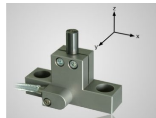
XYZ-Antastelement Positionsbestimmung von Werkzeugen relativ zur Werkstückspannstelle in Bearbeitungszentren. Akustische Erkennung des Reibungsgeräusches, das ein rotierendes Werkzeug bei der Berührung der Diamantflächen erzeugt. Bestückt mit Diamantleisten (PKD) in x-, y- und z-Richtung.
